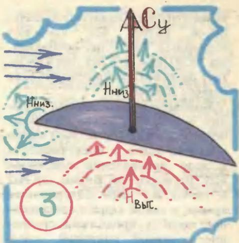
Продувочная модель ЭКИПа (вид сбоку). Благодаря хитроумному распределению скоростей воздуха, вытекающего из щелей впереди и вверху, образовались зоны пониженного давления. Они «засасывают» аппарат вперед и вверх. А возникающая внизу зона повышенного давления еще дополнительно «подталкивает» его вверх.
